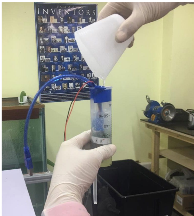
Шаг 5. Заливка элементов эпоксидной смолой
