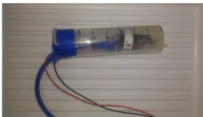
Шаг 4. Подготовка компонентов к заливке эпоксидной смолой
