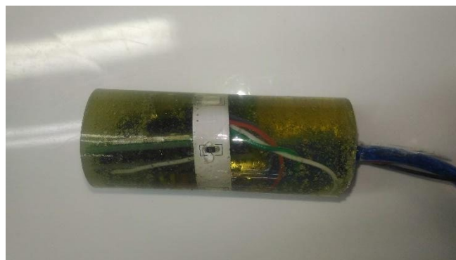
Шаг 6. Извлечение из формы и обработка
