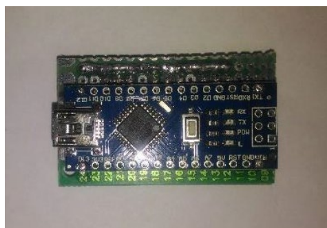
Шаг 2. Пайка основных элементов на макетную плату (с двух сторон)
