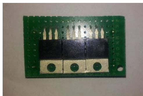
Шаг 2. Пайка основных элементов на макетную плату (с двух сторон)
